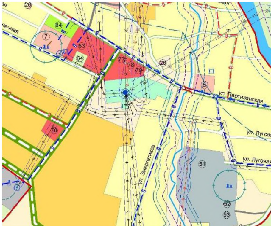
Рисунок 2.1.4.1 – Карта-схема Солонешенского сельского поселения с делением на зоны действия котельной №7 и производственной котельной с индивидуальными автономными отопительными системами
