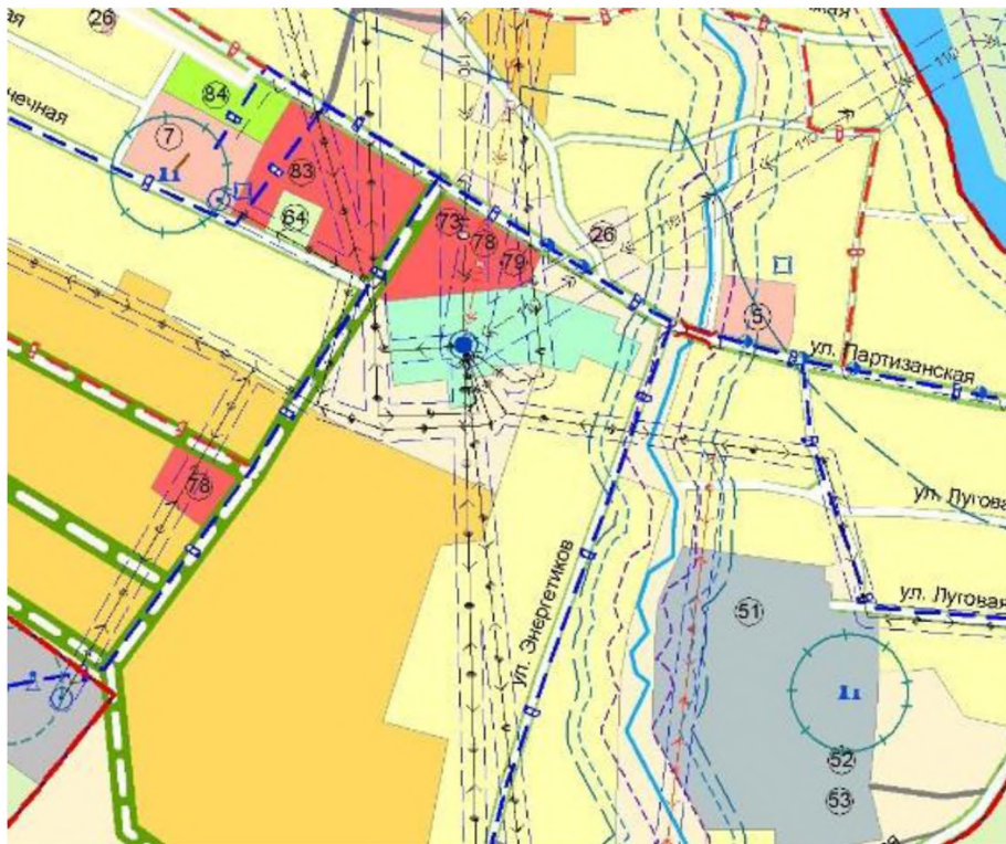
Рисунок 2.1.4.2 – Карта-схема Солонешенского сельского поселения с делением на зоны действия котельных №1, №5, №6 и производственных котельных с индивидуальными автономными отопительными системами
